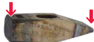
TRATAMENT TERMIC PRIN INDUCTIE PE CAPETE
